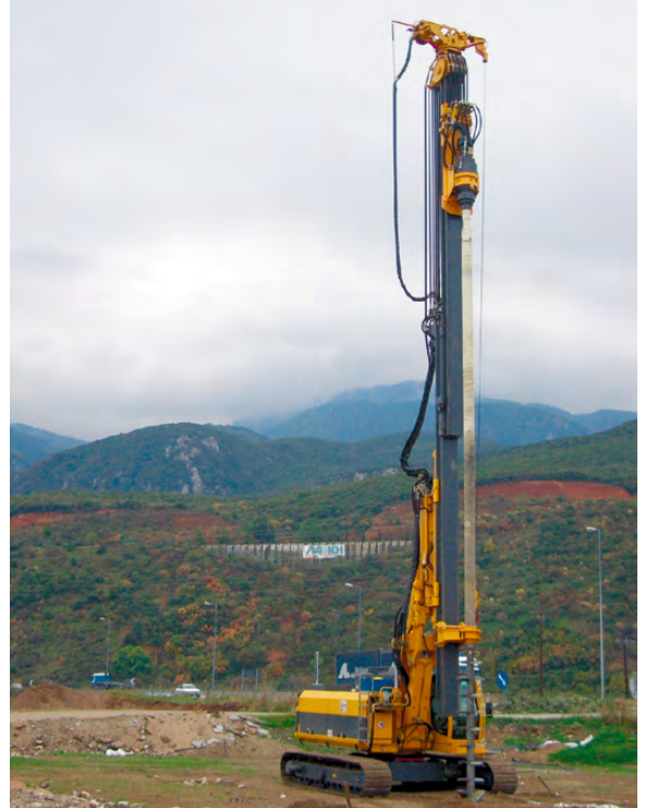
Mezclado de suelo con paleta sencilla en RG 16 T
