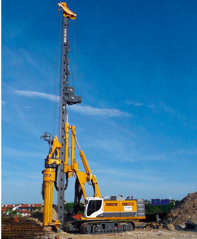
RG 25 S con accionamiento de perforación de doble cabeza DKS 150/300 (Udine, Italia)
