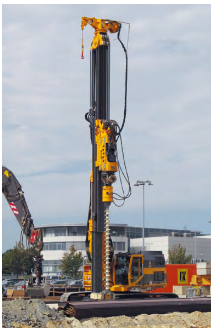
Preperforación con RG 16 T (Alemania)
